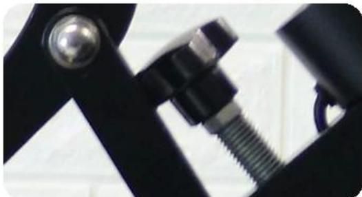
Ручка регулировки давления: для легкой регулировки давления при сублимации предметов разной толщины.
