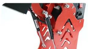
**Высококачественная газовая пружина:** Благодаря газовой пружине термопресс для спортивных мячей открывается плавно и безопасно.
