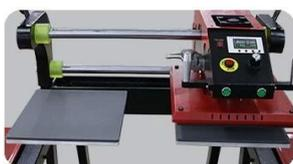
**Двойная рабочая плита:** Эта машина представляет собой двухстороннюю пневматическую печатную машину с двухсторонним теплообменом, оснащенную двумя плитами 40x50 см. Пневматический привод, прост в эксплуатации, экономит время и усилия, любой может легко управлять. Конструкция с двумя станциями также повышает эффективность производства.
