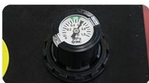
**Регулировка давления:** Устройство регулировки давления установлено на панели управления, и давление можно отрегулировать, потянув вверх и поворачивая ручку.
