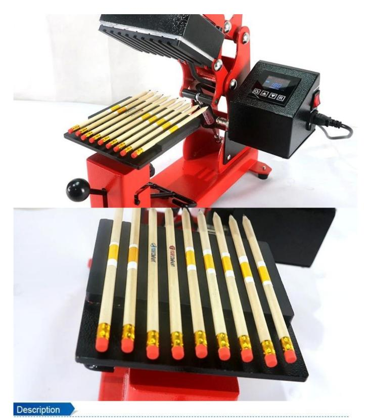
Карандашный термопресс PP-10A3 специально разработан для печати карандашом на дереве. С нагревательным элементом ручки размера 150\*100 мм и базальной силиконовой пресс-формой 150\*100\*10 мм, лазерная машина для переноса карандашей может каждый раз переносить карандаши по 9 шт. Нагрев от 0 до 200 °C, для этого нужно всего 5 минут. Разработанный старшим инженером Microtec  $\Gamma$ -ном Лу, ручка для печати маленький и изысканный.
