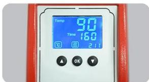
**Цифровой контроллер GY-05N:** Этот контроллер покажет температуру, время установки и количество раз, когда вы использовали эту машину. Светодиодный свет, выглядит более элегантно.
