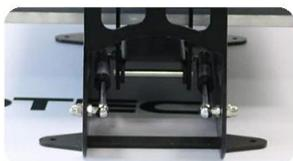
**Двойные газовые пружины:** Модернизированные двойные газовые пружины обеспечивают более плавное открытие термопресса.
