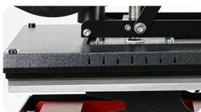
**Возможность большого формата:** MAG-40 оснащен большой термопластиной 60x100 см, что делает его идеальным для работы с материалами большого формата, такими как куски ткани, металлические листы и т. д.
