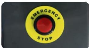
**Аварийный выключатель:** В чрезвычайной ситуации пользователь может нажать этот переключатель, чтобы немедленно остановить работу в целях безопасности.
