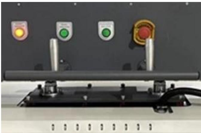
**Безопасное двуручное управление:** это двуручное управление обеспечивает повышенную безопасность, требуя одновременного нажатия кнопок обеими руками. Предотвращает случайное срабатывание, защищает оператора от возможных травм.
