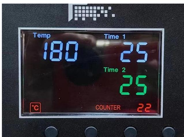
**GY-08 Цифровое время и температура. Контроль:** Удобная цифровая панель управления позволяет точно регулировать время, температуру и давление, позволяя настроить процесс теплопередачи в соответствии с различными материалами.
