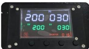
**Цифровой контроллер с сенсорным экраном GY-06:** Интуитивно понятная цифровая панель управления предлагает удобные настройки времени и температуры, что позволяет легко настроить процесс теплопередачи для различных материалов.
