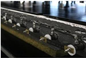
**Отдельные подключаемые тепловые трубки:** Использует тонкую алюминиевую нагревательную пластину с отдельными вставными нагревательными трубками для равномерного распределения тепла и простоты обслуживания, поскольку вы можете заменять неисправные нагревательные трубки по отдельности, сокращая время простоя и затраты.
