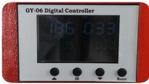
**Цифровой контроллер GY-06:** Оснащен цифровой панелью управления, которая позволяет устанавливать и регулировать температуру и время. Этот точный контроль необходим для достижения наилучших результатов при работе с различными материалами и трансферами.
