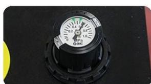
**Регулировка давления:** Устройство регулировки давления установлено на панели управления, давление можно регулировать, потянув вверх и повернув ручку.
