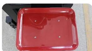
**Двойные лотки для размещения трансферного материала:** Благодаря лотку, предназначенному для каждой станции, вы можете легко загружать и готовить материалы для переноса, пока одна станция работает. Это сводит к минимуму время простоя и оптимизирует рабочий процесс, что приводит к повышению производительности.
