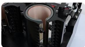
**Высококачественный нагреватель для кружки:** Более прочная упаковка для кружек с более равномерным давлением, большие винты для облегчения замены нагревателя.
