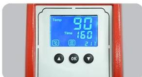
**Controlador Digital GY-05N:** A prensa elétrica automática de canecas usa o controlador digital LED GY-05N para controle preciso sobre as configurações de tempo e temperatura.
