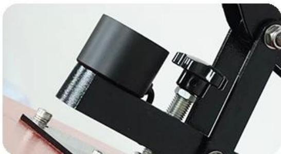
Liberação de abertura automática: Esta prensa térmica de abertura automática utiliza um mecanismo de liberação de eletroímã com uma mola a gás.
