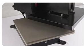
**Segurança do Operador:** O design oscilante não apenas aumenta a pressão, mas também contribui para a segurança do operador, afastando o elemento de aquecimento da área de trabalho durante a colocação e remoção de substratos.
