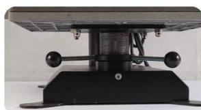
**Controle de pressão ajustável:** A série SA-15/20 apresenta fácil controle de pressão ajustável, permitindo aos usuários personalizar a pressão de acordo com os requisitos de diferentes substratos.
