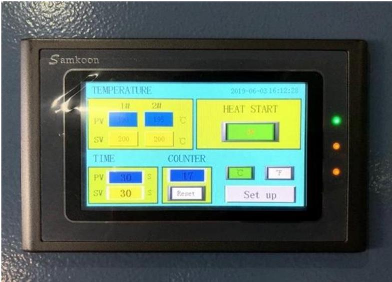
**Controle digital da tela de toque do PLC:** O painel de controle digital fácil de usar permite ajustes precisos de tempo, temperatura e pressão, permitindo que você personalize o processo de transferência de calor para se adequar a diferentes materiais.
