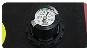
**Ajuste de pressão:** o dispositivo de ajuste de pressão está instalado no painel de operação e a pressão pode ser ajustada puxando para cima e girando o botão.
