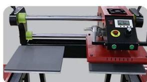
**Placa dupla de trabalho:** Esta máquina é uma máquina de impressão pneumática de transferência térmica de duas estações do tipo shuttle, equipada com 2pcs de placas de base de 40x50cm. Acionamento pneumático, fácil de operar, economiza tempo e esforço, qualquer um pode operar com facilidade. O design da estação dupla também melhora a eficiência da produção.
