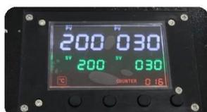
**Controlador digital de tela de toque GY-06:** Este controlador faz com que a prensa térmica pareça mais fashion; É fácil definir o tempo e a temperatura e a máquina de prensagem a quente automaticamente em si.
