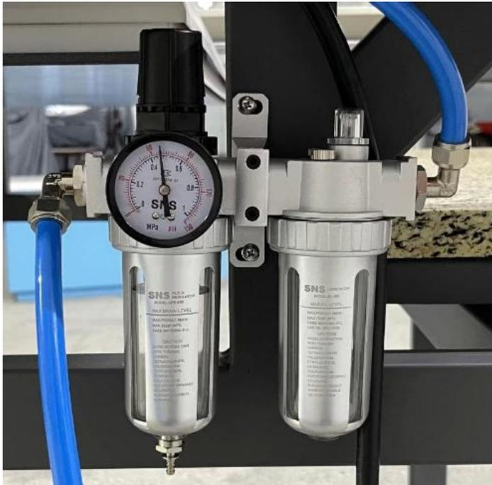
**Sistema de filtro de ar:** o sistema integrado de filtro de ar proporciona melhor qualidade do ar, proteção para máquinas, redução de contaminação, maior segurança e fácil manutenção.
