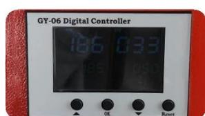
**Controlador de tela sensível ao toque GY-06:** Equipado com painel de controle digital que permite definir e ajustar a temperatura e o tempo. Este controle preciso é essencial para obter os melhores resultados com diferentes materiais e transferências.
