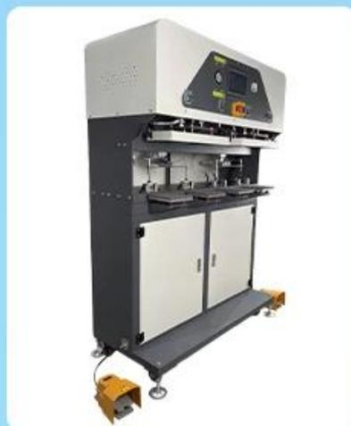
A E4 é uma etiquetadora pneumática totalmente automática, usando o mais recente controlador PLC com tela sensível ao toque da Microtec para um controle de temperatura mais preciso. 4 estações de trabalho para melhorar a eficiência, 2 modos de inicialização (iniciar com as mãos ou pedal). função de transferência de posicionamento, muito fácil e amigável para os usuários operarem em
