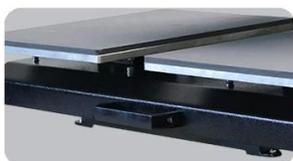
**Controle deslizante esquerdo e direito sob a placa:** O mecanismo de transporte agiliza seu fluxo de trabalho, simplificando o processo de carga e descarga, reduzindo o tempo geral de produção.
