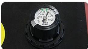
**Ajuste de pressão:** O dispositivo de ajuste de pressão é instalado no painel de operação e a pressão pode ser ajustada puxando para cima e girando o botão.
