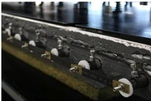
**Tubos de calor plug-in individuais:** Utiliza uma placa de aquecimento de alumínio fino com tubos de aquecimento individuais para distribuição uniforme de calor e fácil manutenção, já que você pode substituir tubos de aquecimento defeituosos individualmente, reduzindo o tempo de inatividade e os custos.
