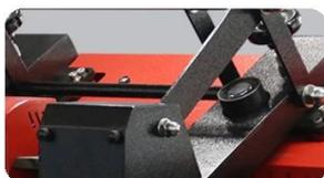
**Liberação de abertura automática:** O recurso de abertura automática permite que a prensa térmica abra automaticamente durante a transferência.
