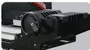
**Alimentação automática e alinhamento:** Equipado com um dispositivo de alimentação que pode alimentar e alinhar os talabartes automaticamente, melhorando muito a eficiência e reduzindo os custos de mão de obra.
