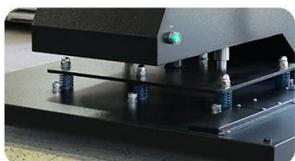
**Pressão de contato vertical:** A cabeça pneumática da placa de aquecimento fornece pressão de contato vertical, facilitando a transferência perfeita de vários materiais sem efeitos de deslocamento.
