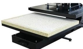
**Deslizar sob a placa:** O design deslizante sob a placa aumenta a conveniência para a colocação do material e garante a segurança contra o calor durante a operação.
