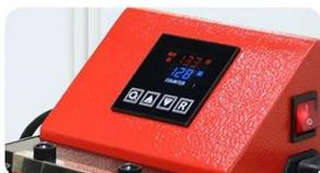
**Controlador digital NTTE-2421WR:** O display digital aumenta a visibilidade e permite que os usuários ajustem facilmente as configurações de acordo com suas necessidades. Além disso, os usuários têm a flexibilidade de escolher a exibição da temperatura em graus Fahrenheit ou Celsius.
