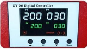
数字 控制器： 用于 设置 温度 和 速度。 显示屏 显示 当前 温度 和 速度。 还可以 设置 温度 和 速度 的 报警 值。
