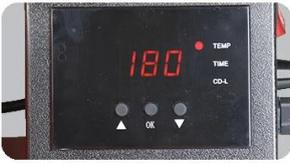
**GY-04** 数位显示屏: 可显示温度、时间、重量。操作方便、准确。
