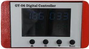
**GY-06** 數位 溫度 控制 器 可 控 製 烘 箱 內 之 溫度 範圍 0~999℃。 溫度 控制 精度 可 達 ±0.5%。
