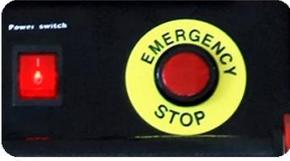
緊急停止ボタン：緊急停止ボタンを押すと、機器が自動的に停止します。
