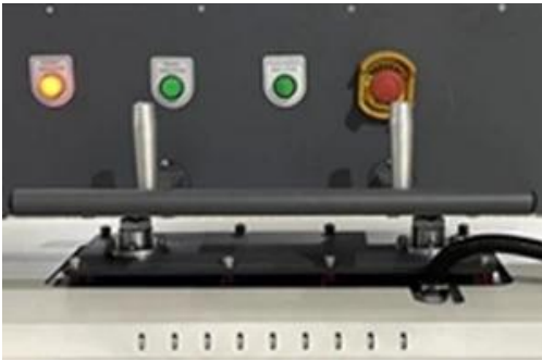
控制面板 (Control Panel): 用於操作機械設備的各個功能，包括開關、急停及速度調節。
