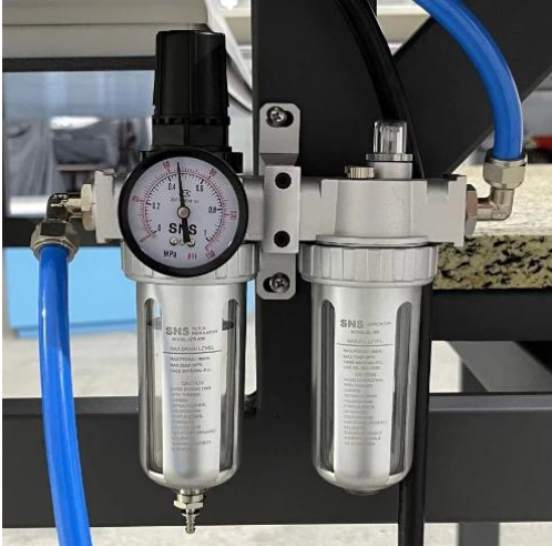
空氣過濾調節器 (Air Filter Regulator): 用於過濾壓縮空氣中的雜質並調節壓力。
