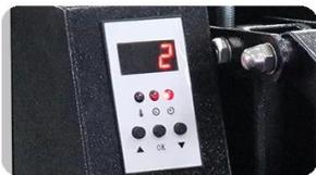
**Controllore digitale GY-04N:** Forma verticale del controller per mostrare tempo e temperatura precisi.
