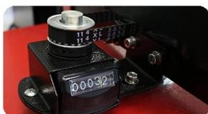
**Lettura della contropressione del filo digitale:** La funzione di lettura della pressione semplifica la regolazione della pressione, può registrare valori di pressione diversi per diversi materiali, risparmiando tempo di regolazione della pressione;
