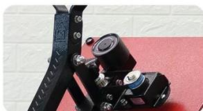
**Rilascio magnetico di apertura automatica:** Non richiede alimentazione d'aria, questa termopressa ad apertura automatica utilizza un meccanismo di rilascio dell'elettromagnete con una molla a gas.
