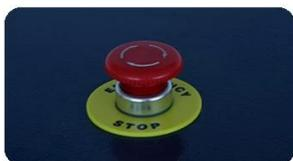
**Interruttore di arresto di emergenza:** In caso di emergenza, l'operatore può premere questo interruttore per interrompere l'operazione.
