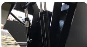
**Forte molla a gas:** Con 4 molle a gas da 135 kg, la macchina funziona con una pressione uniforme e mantiene costantemente il risultato del trasferimento.
