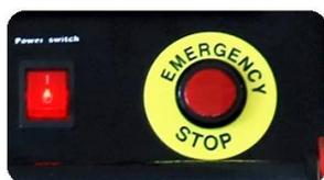
**Interruttore di arresto di emergenza:** Con l'interruttore di emergenza è possibile evitare incidenti ed errori durante il funzionamento della termopressa automatica aperta di grande formato.
