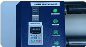
**Controller digitale: Controllo separato della temperatura e controllo della velocità di trasformazione; È facile impostare l'ora, la temperatura e la velocità. Più preciso dell'ora e della temp. Schermo**
