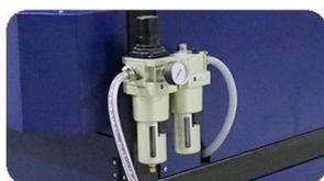
**Filtro dell'aria:** Per regolarne la pressione, facile da usare e da mantenere.
