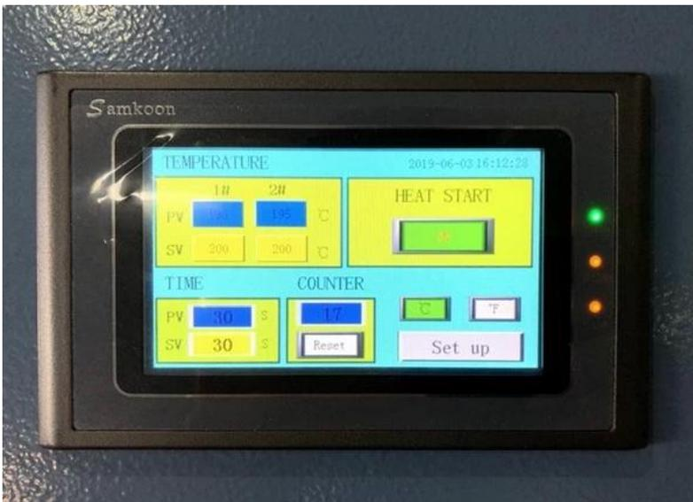
**Controllo digitale touch screen PLC:** Il pannello di controllo digitale intuitivo consente regolazioni precise delle impostazioni di tempo, temperatura e pressione, consentendo di personalizzare il processo di trasferimento del calore per adattarlo ai diversi materiali.
