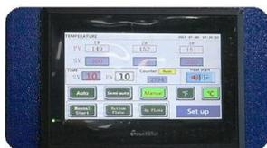
**Controller digitale touch screen PLC:** Dotata di un controller touch screen digitale PLC, questa termopressa consente un controllo preciso della temperatura di ciascun tubo di calore. Ciò garantisce una distribuzione uniforme del calore su tutta la piastra, promuovendo trasferimenti coerenti e di alta qualità.
