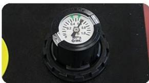
**Regolazione della pressione:** Il dispositivo di regolazione della pressione è installato sul pannello operativo e la pressione può essere regolata tirando verso l'alto e ruotando la manopola.
