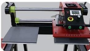
**Doppia piastra di lavoro:** Questa macchina è una macchina da stampa pneumatica a trasferimento termico a due stazioni di tipo navetta, dotata di 2 pezzi di piastre di base 40x50 cm. Azionamento pneumatico, facile da usare, risparmia tempo e fatica, chiunque può facilmente operare. Il design a doppia stazione migliora anche l'efficienza produttiva.
