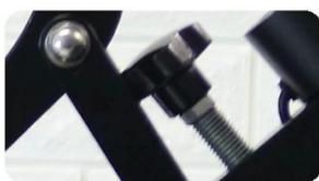
**Facile regolazione della pressione:** Una manopola rotante consente semplici regolazioni dell'impostazione della pressione prima, durante o dopo la procedura di pressatura a caldo, offrendo flessibilità e controllo.
