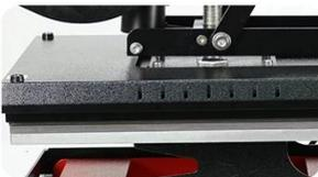
**Capacità di grande formato:** La MAG-40 è dotata di un'ampia piastra termica da 60x100 cm, che la rende particolarmente adatta per materiali di grande formato come pezzi di stoffa, lamiere e altro ancora.
