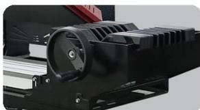
**Dispositivo di alimentazione:** Cordino di alimentazione roll-to-roll, è facile da usare e aiuta a posizionare il cordino in modo uniforme per un migliore effetto di trasferimento;
