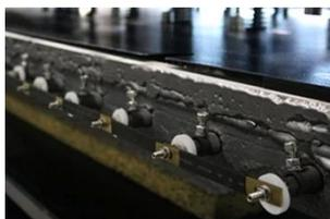
**Tubi di calore plug-in individuali:** Utilizza una sottile piastra riscaldante in alluminio con singoli tubi riscaldanti plug-in per una distribuzione uniforme del calore e una facile manutenzione, poiché è possibile sostituire singolarmente i tubi riscaldanti difettosi, riducendo tempi di fermo e costi.
