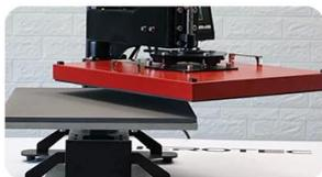
**Design oscillante:** Lo speciale design oscillante fornisce un accesso completamente senza ostacoli alla piastra inferiore, consentendo un facile caricamento degli indumenti e il posizionamento dei trasferibili.
