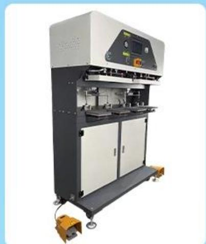
E4 è un'etichettatrice pneumatica completamente automatica, che utilizza l'ultimo Controllore PLC touch screen di Microtec per un controllo più preciso della temperatura. 4 stazioni di lavoro per
