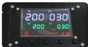
**Controller digitale touch screen GY-06:** L'intuitivo pannello di controllo digitale offre impostazioni intuitive per tempo e temperatura, semplificando la personalizzazione del processo di trasferimento del calore per diversi materiali.
