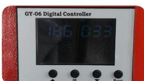
**Controllore digitale GY-06:** Dotato di un pannello di controllo digitale che permette di impostare e regolare sia la temperatura che il tempo. Questo controllo preciso è essenziale per ottenere i migliori risultati con materiali e trasferimenti diversi.
